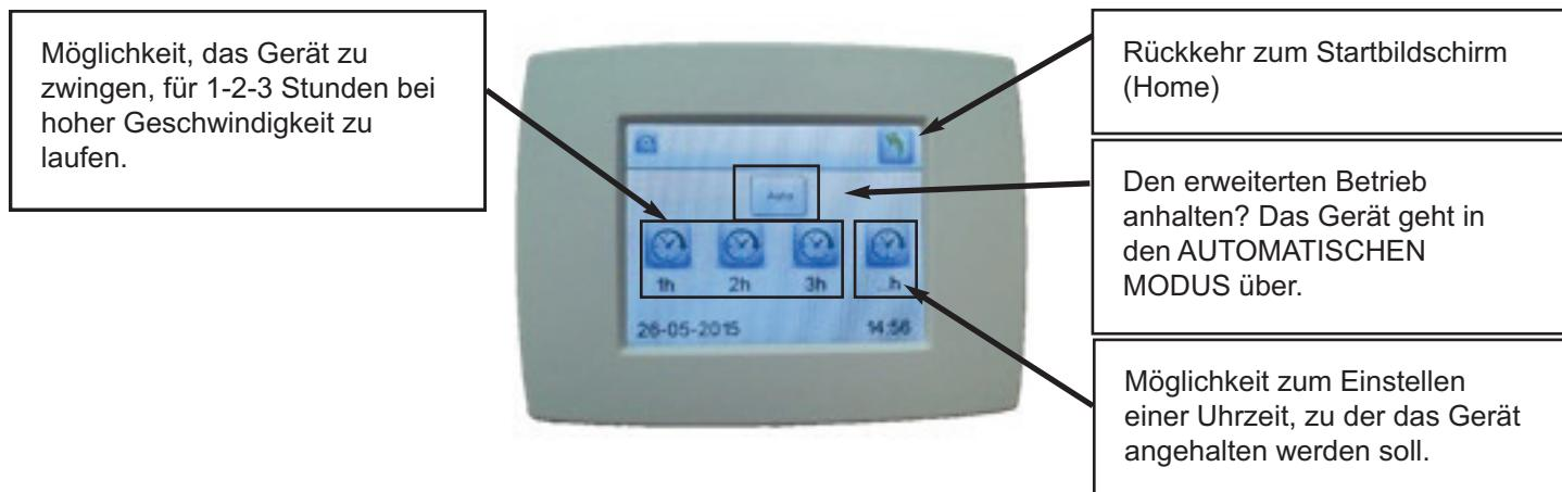
Hinweis: Der erweiterte Betrieb deaktiviert die Uhren. Am Ende des erweiterten Betriebs werden die Uhren aktiviert, damit die Maschine weiter funktionieren kann.
